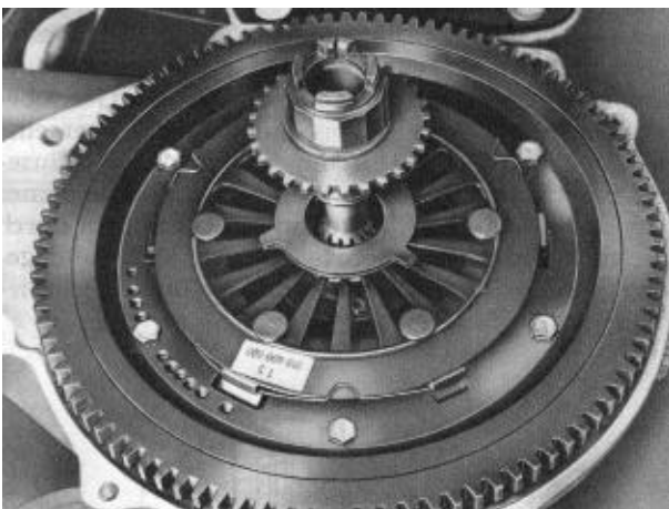
Bild M 74. Mitnehmerscheibe zentrieren
