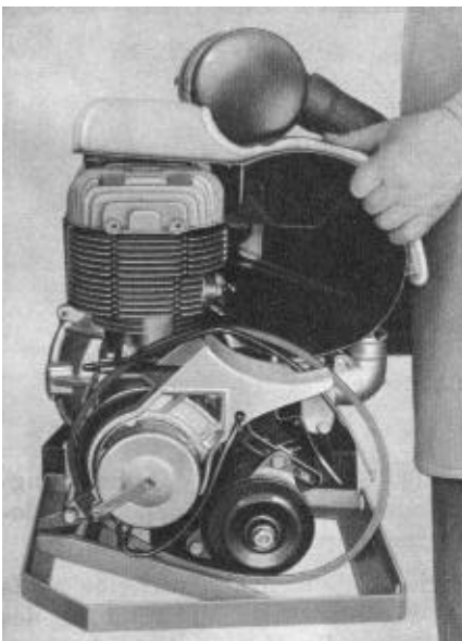
Bild M 13. Kühlluftgehäuse abnehmen
