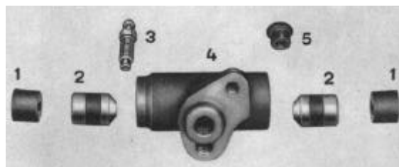
Bild F 53. Radbremszylinder - hinten
