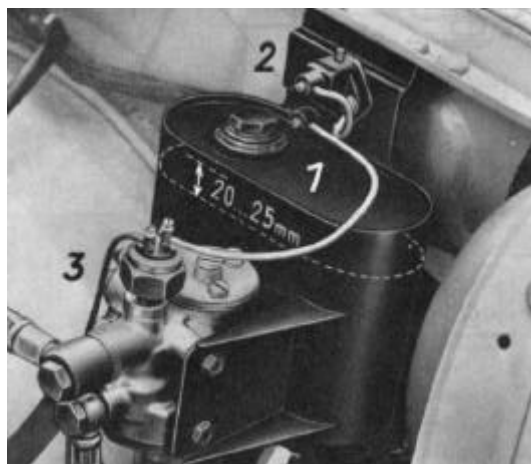
Bild H 15. Hydraulikölbehälter (1) Hydraulikölbehälter (2) Sicherheitsschalter - mechanisch (3) Sicherheitsschalter - hydraulisch
