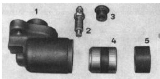
Bild F 52. Radbremszylinder - vorn
