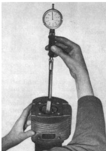
Bild M 36. Zylinderbohrung messen
