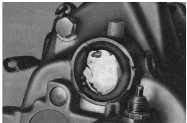
Bild G 20. Farbmarkierung am Ausgleichgetriebe
