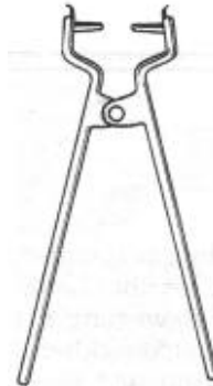
Zange zum Aus- und Einhängen der Bremsbacken
