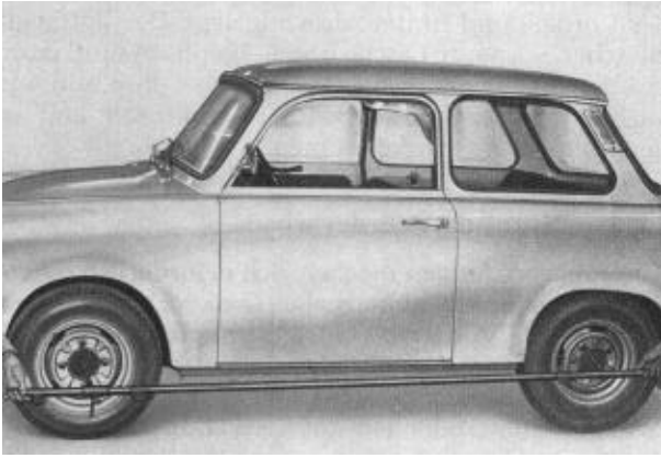
Bild F 22. Radstand überprüfen
