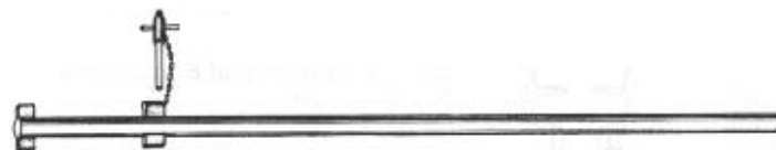
Spannhebel für Vorderfeder
