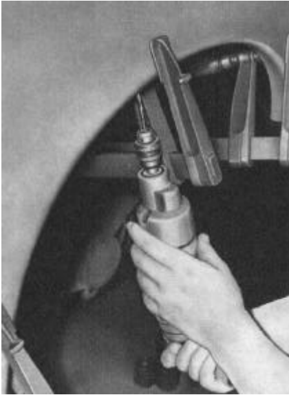
Bild K 16. Nietlöcher bohren
