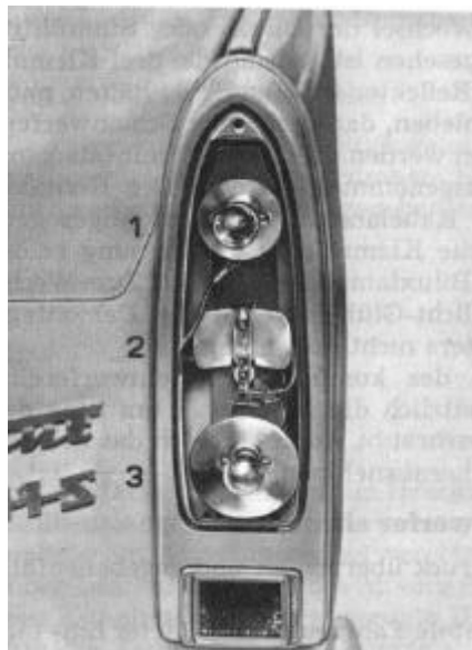
Bild E 22. Brems-Schluß-Blink-Leuchte
