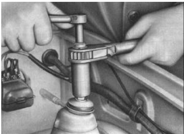
Bild F 38. Stoßdämpferbefestigung lösen
