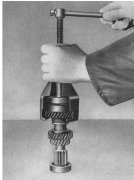
Bild G 12. Rillenkugellager und 4. Gangrad abziehen
